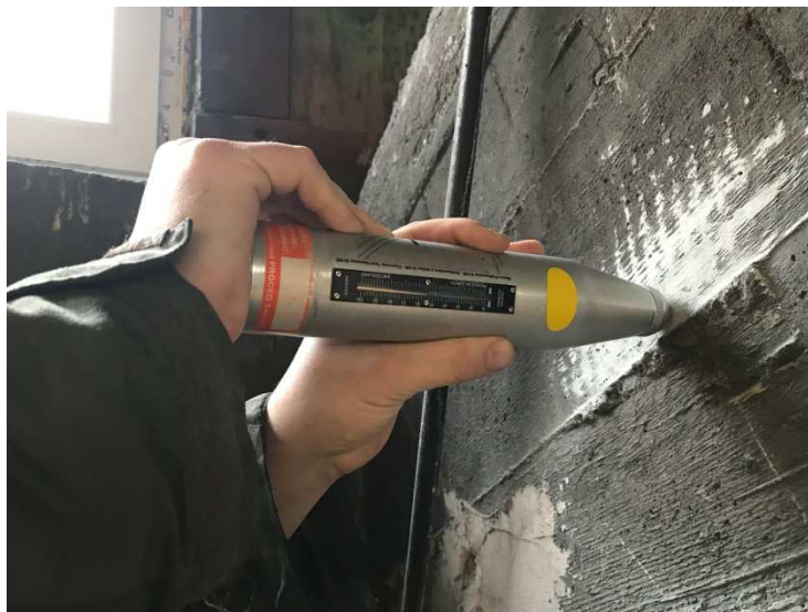
Fot. 31 – Badanie sklerometryczne górnego pasa dźwigara
